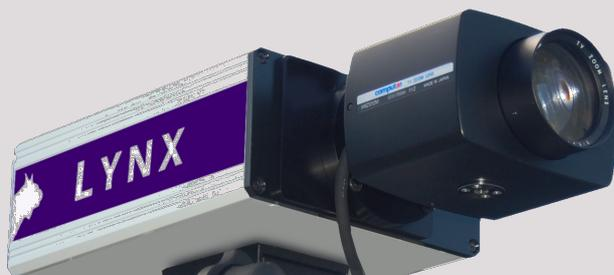
fernbedienbare Zoomoptik: - Zoom, Blende und Schärfe werden mittels Software fernbedient
