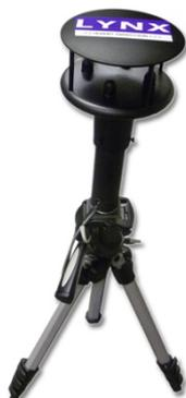
**Der Ultraschall Windmesser** des Systems enthält keine beweglichen Teile und entspricht den neuesten IAAF Standards. Die Einbeziehung der Windmessung in die einzelnen Läufe findet voll automatisch statt und wird auch mittels der FinishLynx Software kontrolliert.
