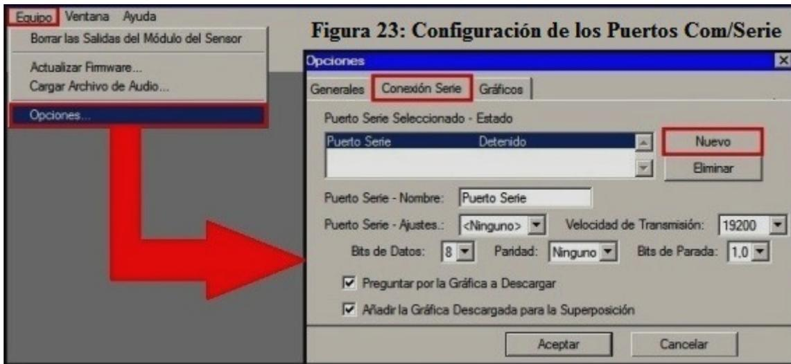
**Figura 23: Configuración de los Puertos Com/Serie**
